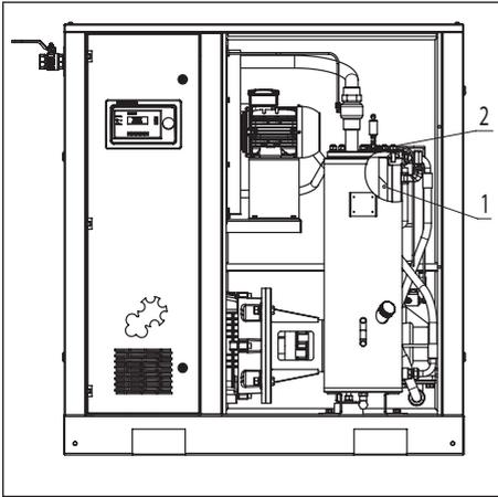
Das Separatorbauteil (1) ist innerhalb des Separatorbehälters angeordnet. Öffnen Sie das Frontpanel, um es auszutauschen. Lösen Sie die Schrauben (2) und entfernen Sie sorgfältig den Deckel auf der Behälteroberseite. Lösen Sie dafür bei Bedarf einige Schlauchanschlüsse. Entfernen Sie den verbrauchten Separator und installieren an einen neuen. Montieren Sie den Behälterdeckel wieder vollständig.
