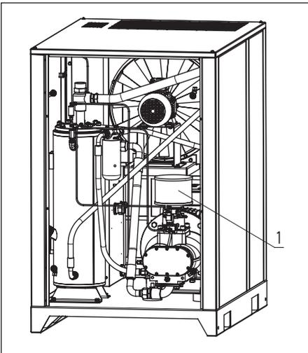
Der Luftfilter (1) ist am Einlassventil des Kompressors angeordnet. Öffnen Sie das Frontpanel und entfernen Sie die Schelle. Sie können den verschmutzten Luftfilter und die Befestigungsschelle sicher demontieren. Nun setzen Sie den Filter ein und fixieren ihn erneut.
