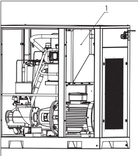
Öffnen Sie das Frontpanel um den Wärmeaustauscher (1) zu erreichen. Reinigen Sie den Wärmeaustauscher regelmäßig um die Kühlfunktion optimal zu halten. Entfernen Sie Staub und Schmutz mit einer weichen Bürste, dann blasen Sie den Wärmeaustauscher von unten nach oben mit Druckluft ab. Die Düse sollte im 90° Winkel zu der Kompressorebene gehalten werden.
