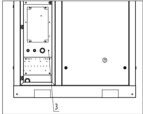
Bild 3.5.2 Stromkabel Klemmverbindungen
