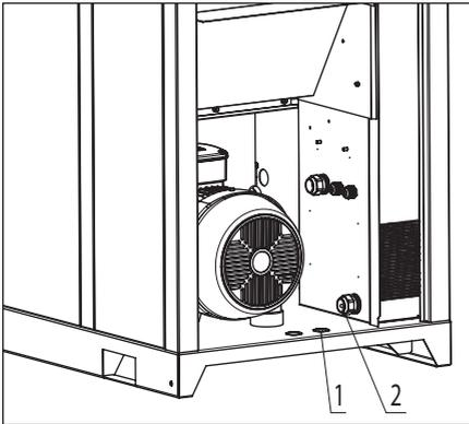
Bild 3.5.1 Stromkabelverbindung
