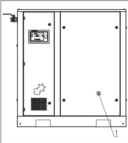
Kontrollieren Sie den Ölstand täglich. Um den Ölstand zu erreichen, stoppen Sie den Kompressor und entfernen Sie das Frontpanel. Der Ölstand kann visuell am Ölstandsanzeiger (1) des Kompressors abgelesen werden, wenn dieser abgeschaltet ist. Der Ölstand muss immer im Sichtglas zu erkennen sein. Wenn dies nicht der Fall ist, muss neues Öl nachgefüllt werden. Nutzen Sie ein Vorspannungsmessgerät, um die Spannkraft des Riemens zu prüfen.
