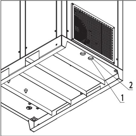
Bild 3.6.1 Stromkabelverbindung
