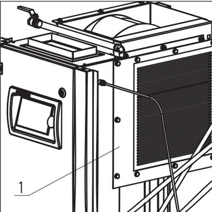
Öffnen Sie das Frontpanel um den Wärmeaustauscher (1) zu erreichen. Reinigen Sie den Wärmeaustauscher regelmäßig um die Kühlfunktion optimal zu halten. Entfernen Sie Staub und Schmutz mit einer weichen Bürste, dann blasen Sie den Wärmeaustauscher von unten nach oben mit Druckluft ab. Die Düse sollte im 90° Winkel zu der Kompressorebene gehalten werden.
