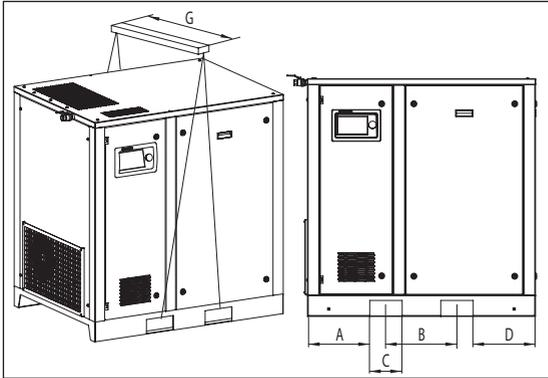
Für den Transport mit dem Gabelstapler, nutzen Sie die Transportlanglöcher im Gestell. Der Kompressor hat Transportlanglöcher mit einer Breite von C – Bild 5. Bewegen Sie den Kompressor vorsichtig.
