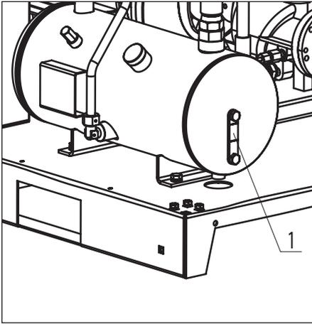
Kontrollieren Sie den Ölstand täglich. Der Ölstand kann visuell am Ölstandsanzeiger (1) des abgeschalteten Kompressors abgelesen werden. Der Ölstand muss immer im Sichtglas zu erkennen sein. Wenn dies nicht der Fall ist, muss neues Öl nachgefüllt werden.
