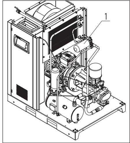
Bild 5.3.3 Austausch des Ölfilters D18 – D22
