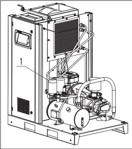
Bild 5.3.2 Austausch des Ölfilters D11 – D15
