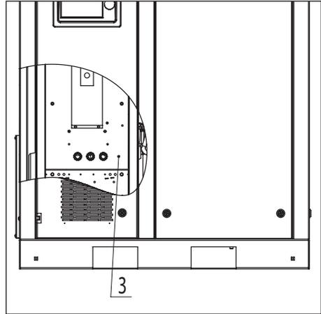
Bild 3.6.2 Stromkabel Klemmverbindungen
