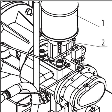
Der Luftfilter (1) ist am Einlassventil des Kompressors angeordnet. Öffnen Sie das Frontpanel und entfernen Sie die Schelle (2). Sie können den verschmutzten Luftfilter und die Befestigungsschelle sicher demontieren. Nun setzen Sie den Filter ein und fixieren ihn erneut.
